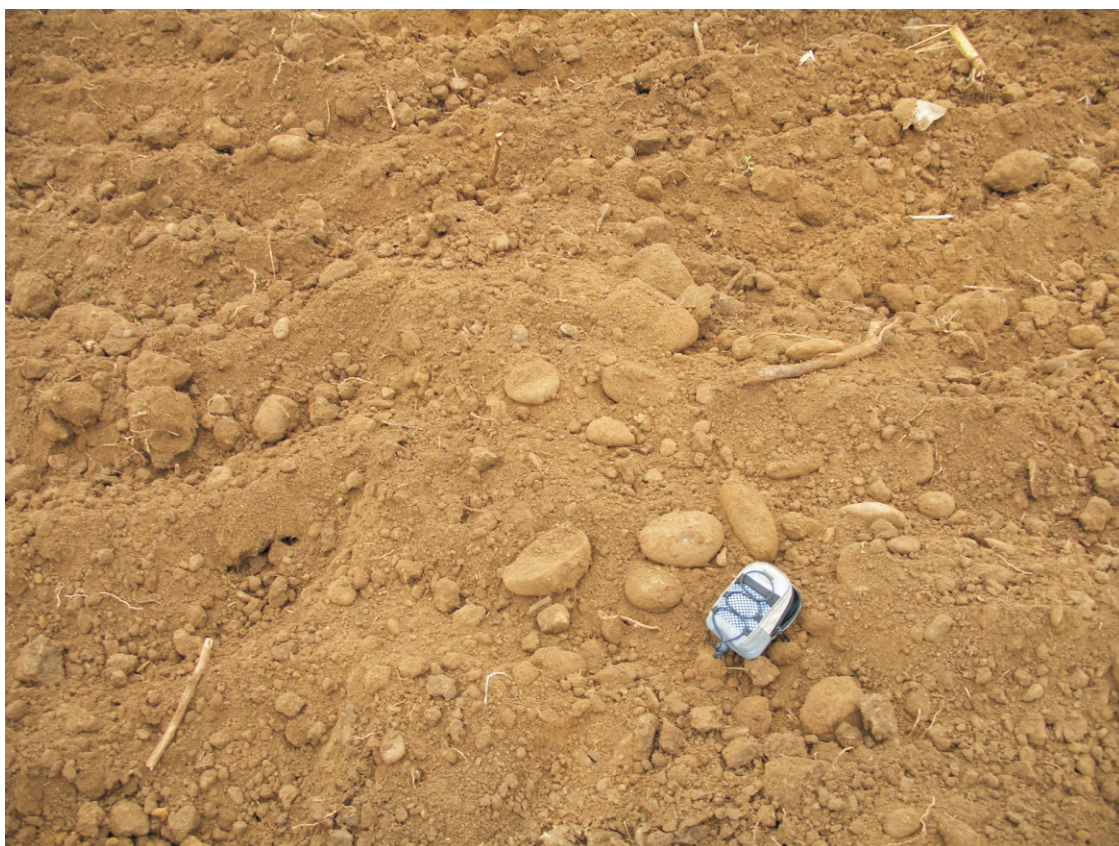
Foto 3: dettaglio dei depositi ghiaioso - sabbiosi presenti in sito (rimaneggiati).
